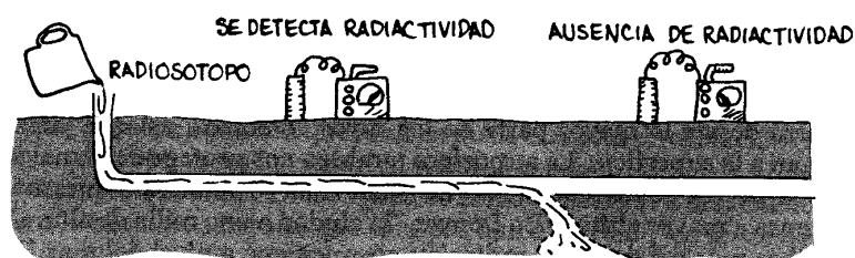
Figura 16 Otra aplicación de los isótopos radiactivos como indicadores es la de localizar fugas de agua en tuberías.
